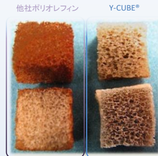
Y-CUBE®内部に付着した微生物
